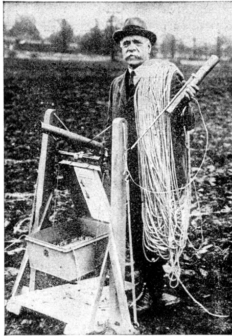
ilyen készülékkel lövik át a mentőkötetet a veszélyben levő hajóra. A csőből kilőtt rakéta 250 méter hosszú kötelet visz magával
